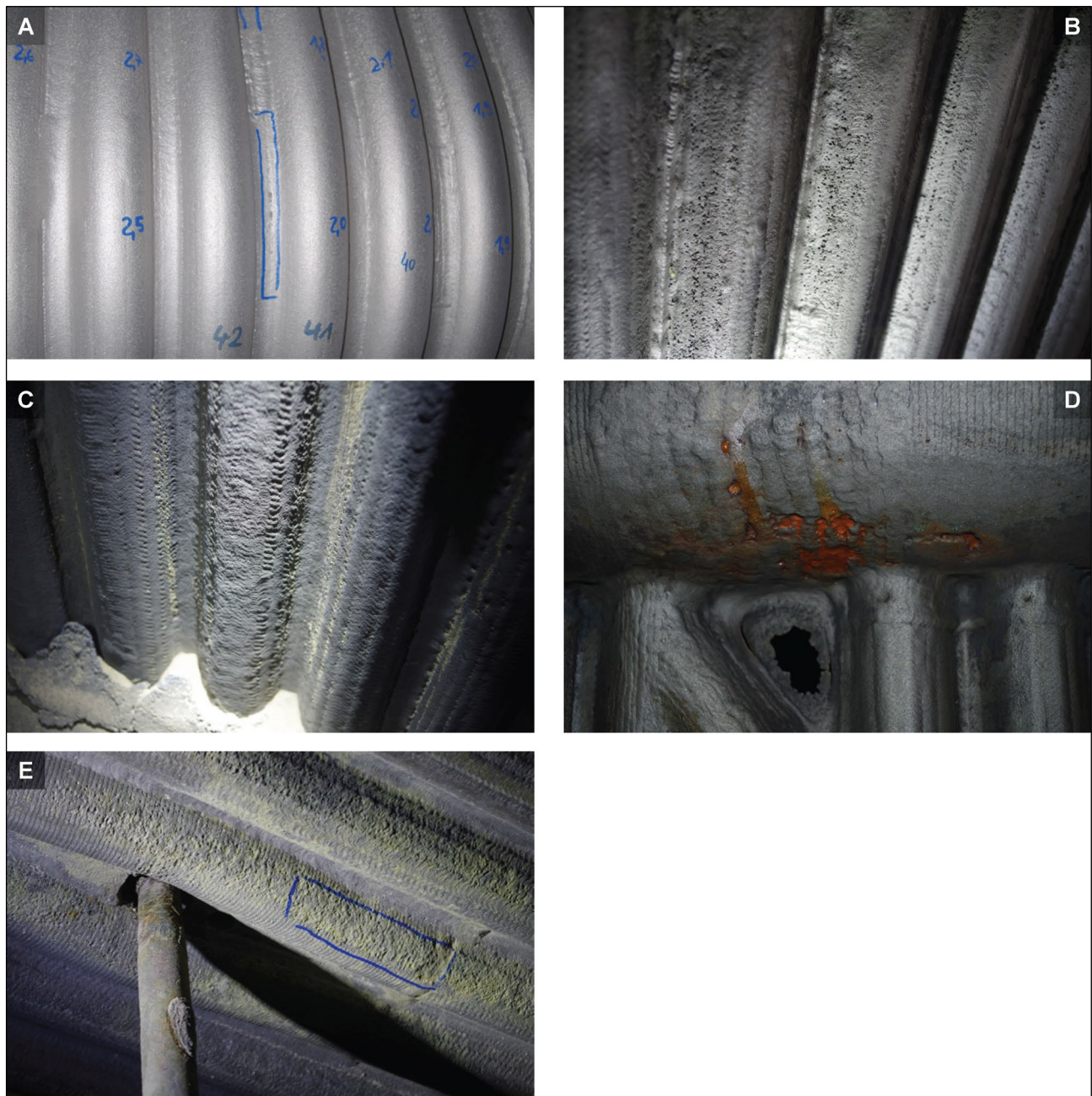
Abbildung 3: Beispielfhafte Darstellung der Zonen mit erhöhtem Verschleiß
