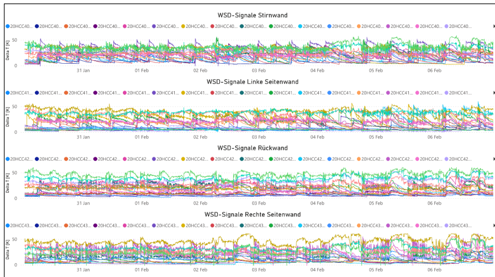
Abbildung 3: Signalverläufe der ermittelten Temperaturdifferenzen je Seitenwand.
