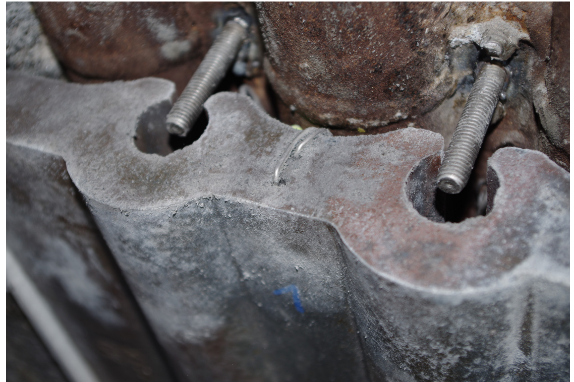
Thermoelemente in hintergossener Platte
