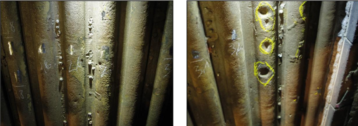
*Bild 4: Zustand der Rohrwand nach Ausbruch der Plattenzustellung an der RSW im Bereich der hintergossenen Platten: Es ist ein Korrosionsangriff auf die Rohrwand zu erkennen, zudem kam es beim Ausbruch der Platten zur Schädigung der Rohrwand (Schlagschäden)*
