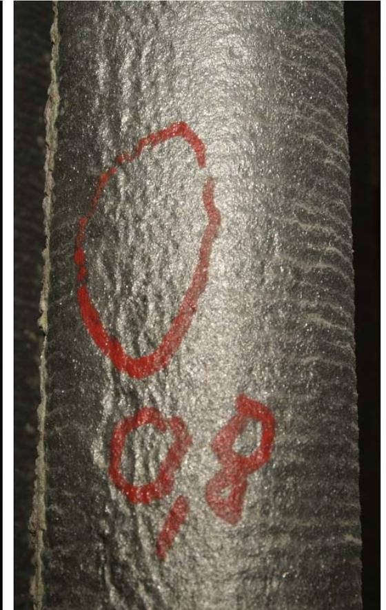
c) Lokal invasiver Korrosionsangriff liegt in Form von Rillen quer zum Schweißnahtgefüge vor.
