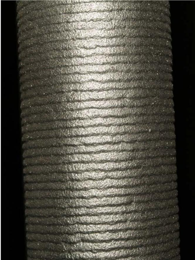
a) Flächiger Korrosionsangriff in Form kleiner Korrosionsmulden sorgt für ein gleichmäßiges Zurückweichen der Plattierungsfläche
