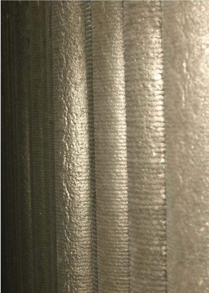
Abb. 7: Überhitzerrohre gecladdet mit Alloy 686 in Spiralschweißung, nach ca. 3 Jahren Betriebszeit, TRG(a)= ~ 750°C; TOF(b)= ~480°C
