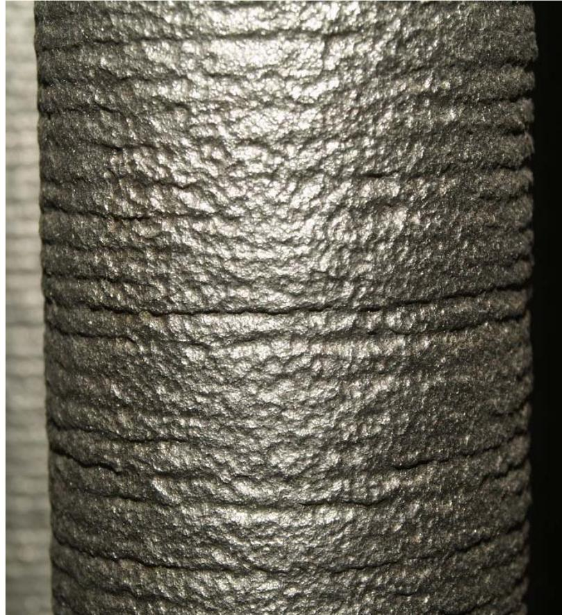
b) Selektiver Korrosionsangriff entlang von Schweißnahtüberlappungen führt zu einer Reliefumkehr. Ehemals erhabene Bereiche werden eingetieft.
