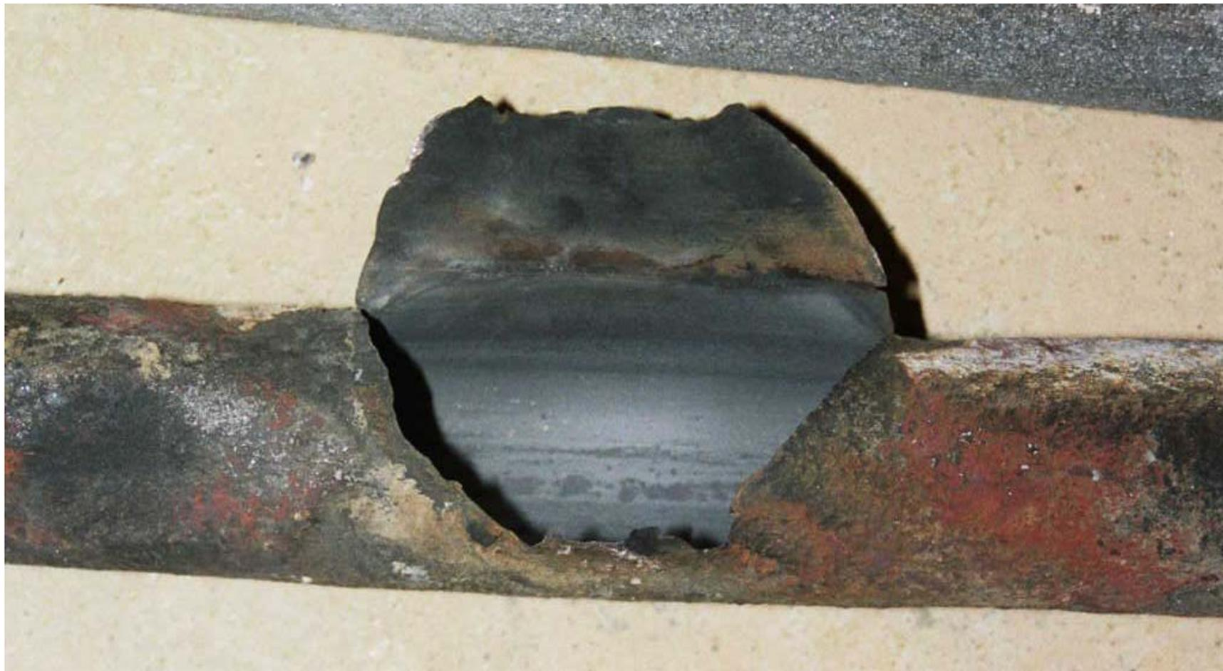
Abb. 2: "Rohrreißer" - Bei Erreichen einer kritischen Minimalwanddicke öffnet der Dampfdruck das Rohr und das Medium kann wie oben dargestellt z.B. in einem 2 F-Fall austreten.
