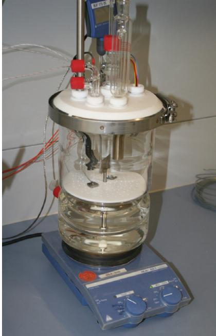
Im Labor können in Reihenversuchen unterschiedliche korrosive Agenzien und Werkstoffe getestet werden, Bild 9. Eine Beurteilung der relativen Korrosivität unterschiedlicher Stoffe und Stoffkonzentrationen (im Elektrolyten) sind möglich. Die Bedingungen der Korrosionsversuche können u.a. in Bezug auf Feuchte, Sauerstoffgehalt und Materialtemperaturen konstant gehalten werden. Beispiele aus den Versuchen zeigen Bild 3 und Bild 4.
