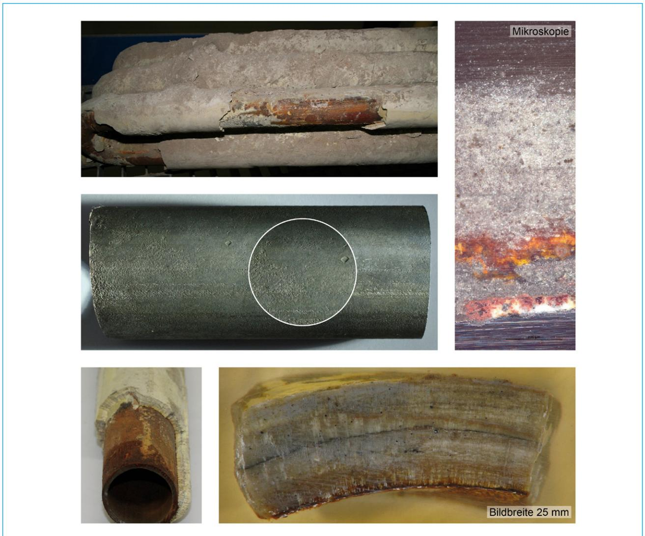
*Bild 7: Provakationstest in einer MVA mit Mediumstemperatur 90°C, Rauchgastemperatur etwa 235°C nach etwa 4.000 Bh unter Einfluss der SNCR. Ungereinigtes und gereinigtes Rohr (Korrosionsmorphologie im streifenden Licht), Belagsaufbau und Schliffpräparat (unten) sowie mikroskopisches Bild der rohrnahen Zone (rechts oben). Die analytische Untersuchung der stängeligen Belagsschicht sowie der rohrnahen Zone ergibt Ammoniumchlorid, darunter chloridische Korrosionsprodukte des Rohrwerkstoffs.*
