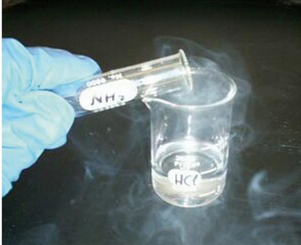
Bild 11: Gasförmiges  $\text{NH}_3$  bildet mit gasförmigem  $\text{HCl}$  feste, weiße Kristalle. Quelle: Wikipedia, Stichwort „Ammoniumchlorid“
