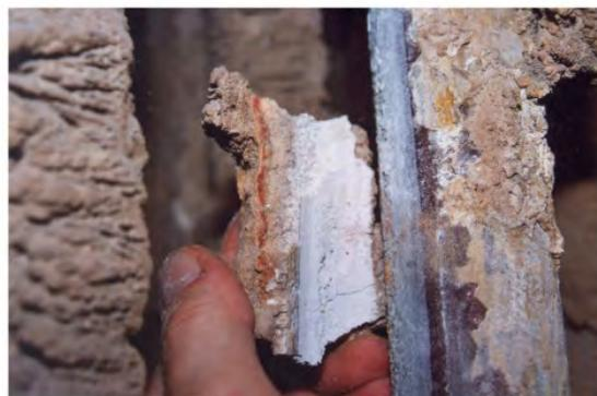
*Bild 5: Beläge auf Wärmetauscherflächen (Verschmutzung)*
