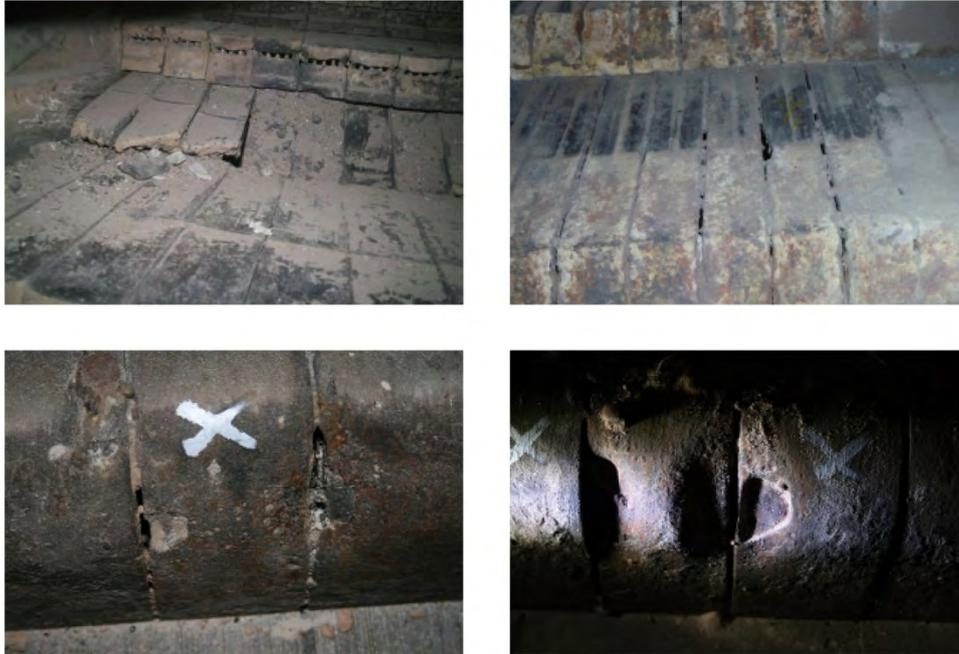
*Bild 25: Abzehrung an Werkstoffen in der Feuerung*
