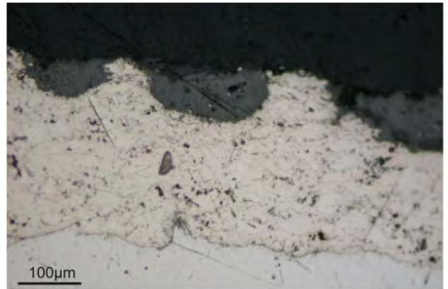
*Bild 28: Korrosionsphänomene an thermisch gespritzten Schutzschichten*
