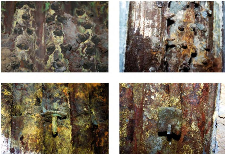
*Bild 26: Korrosion metallischer Halteteile von keramischen Schutzschichten*
