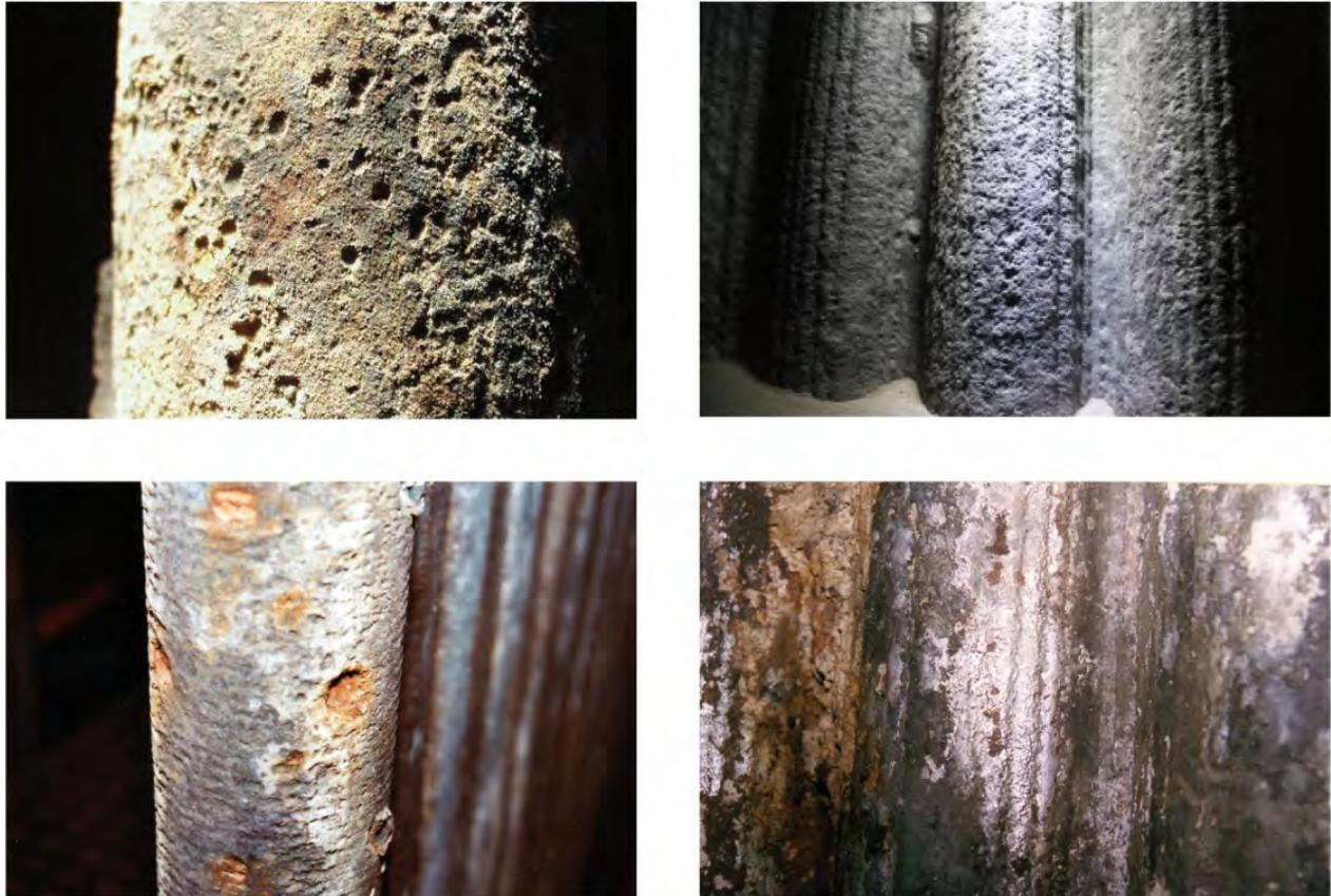
*Bild 13: Korrosionsphänomene der Salzschnmelzenkorrosion*
