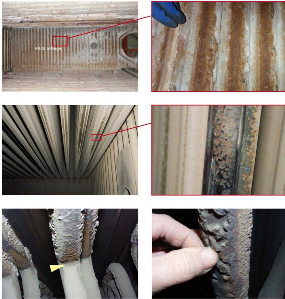
*Bild 14: Phänomene der Erosionskorrosion*
