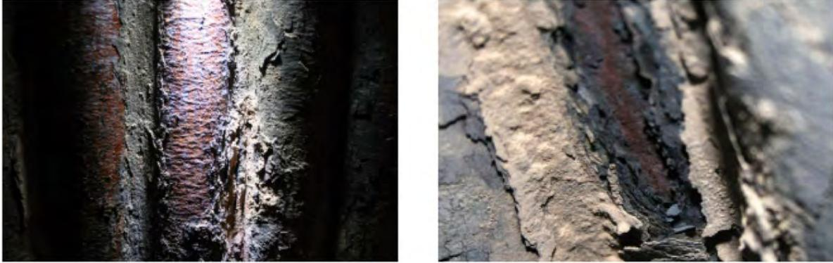
*Bild 8: Blättereartige Korrosionsprodukte auf Verdampferrohren*
