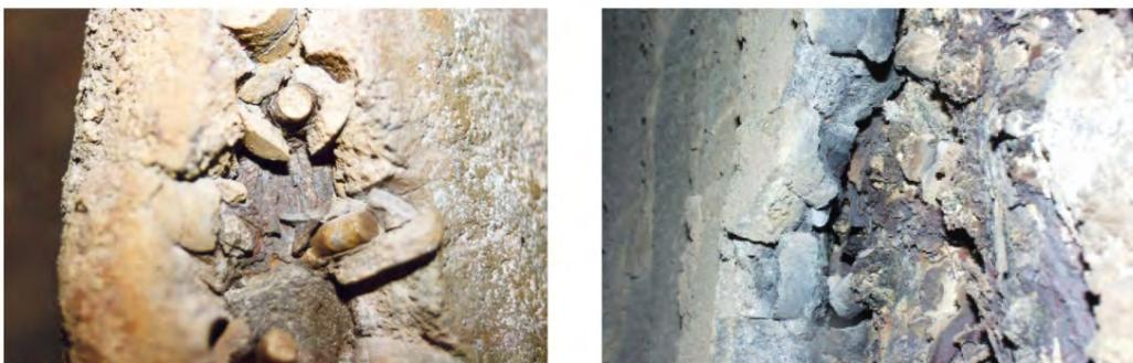
*Bild 27: Unterkorrosion bei keramischen Schutzschichten*
