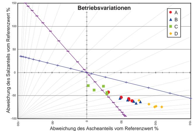
Die chemische Zusammensetzung jeder Entnahme kann zu einem Lagepunkt im ASP-Diagramm verrechnet werden. Das ASP-Diagramm setzt zwei summative Parameter in Beziehung, den „Asche-Anteil“ und den „Salz-Anteil“. Günstige und ungünstige Variationen von Brennstoff und/oder Feuerungen lassen sich damit bewerten.
