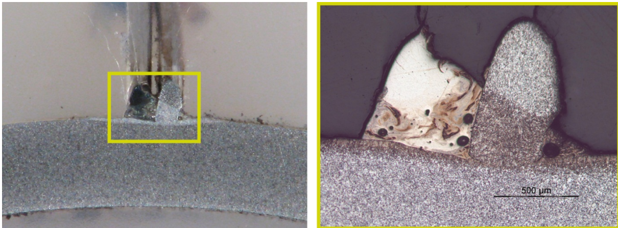
Abb. 1: Schnitt durch eine Aufsweißung eines Thermodrahtpaares (Oberfläche geätzt). Diese Art der Installation ergibt eine ideale Verbindung zum Grundwerkstoff (kein Spalt) und nahezu keine Wärmeinflusszone am Grundwerkstoff (<0,1 mm). Es ist sichergestellt, dass eine exakte Messung der Materialtemperatur erfolgt.
