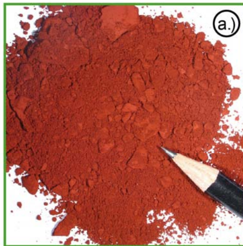
XRD: Eisenoxid, Ammoniumeisenchlorid
