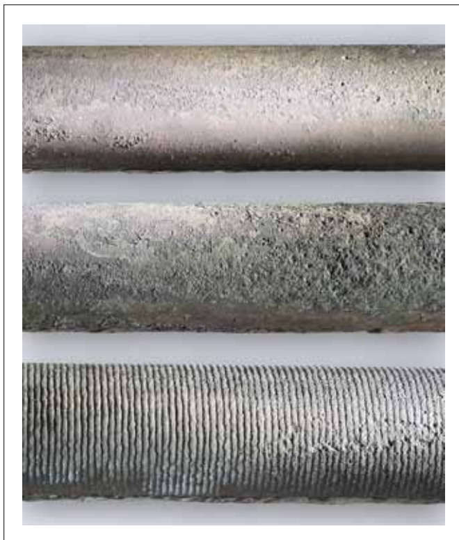
Abb. 4: Werkstoffsonden, Oberflächenmorphologie verschiedener Schutzschichten (nach Abreinigung) in unterschiedlichen Temperaturbereichen, eingesetzt zwischen 1.000 und 1.700 h im Überhitzerbereich. Mit steigender Temperatur (von links nach rechts) nimmt der Korrosionsangriff zu.
