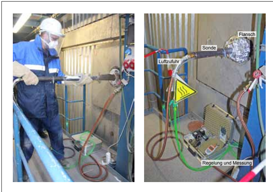
Abb. 3: Einsatz der Sonde Vor-Ort.
